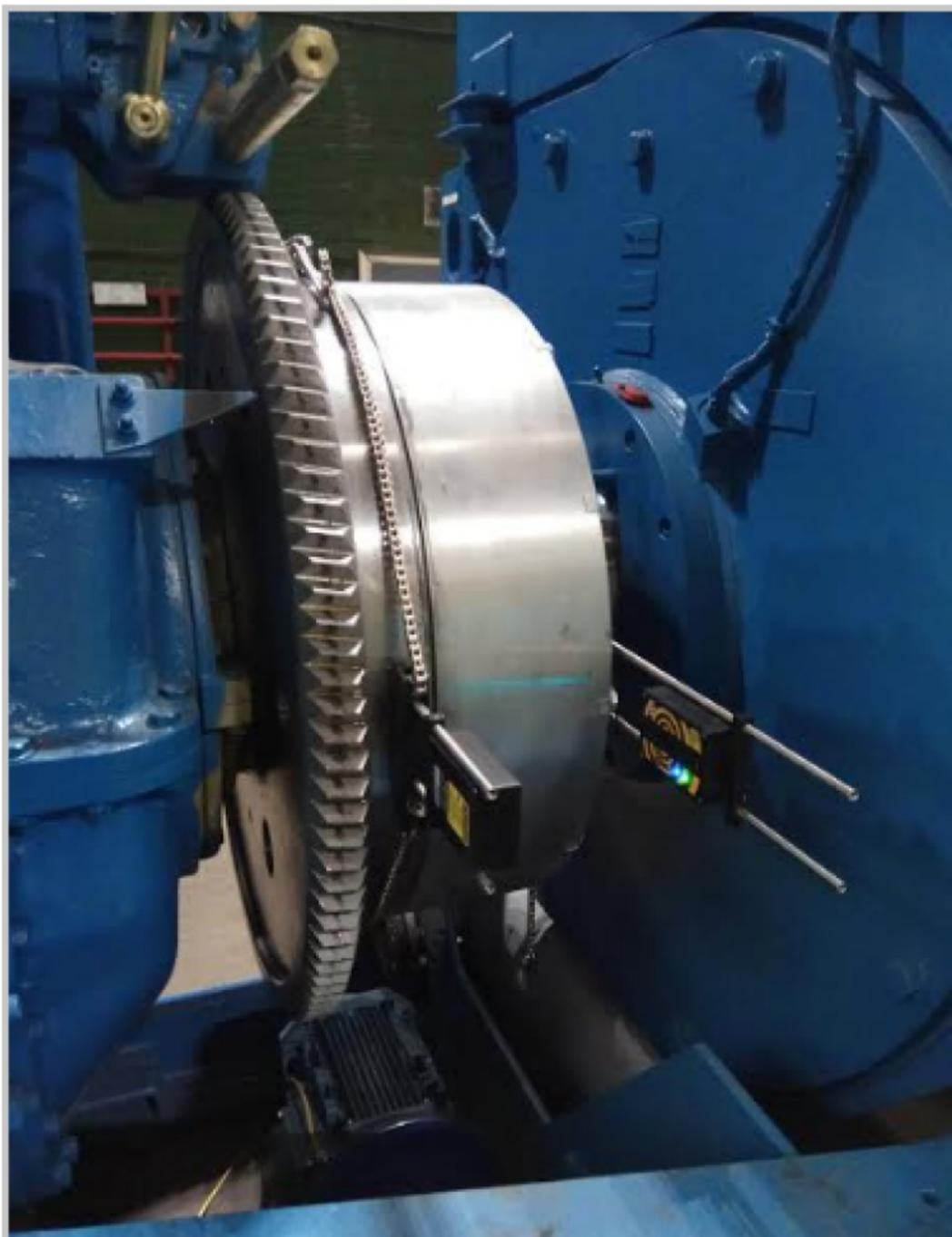
2. Если перемещение измерительных блоков точно в положения 3, 6, 9, 12 часов (+/- 3°), из-за конструктивных особенностей агрегата, невозможно.
