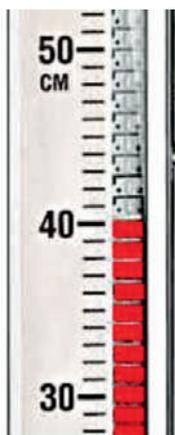
Магнитный указатель уровня состоит из герметичной внешней камеры, поплавка с магнитом и показывающего табло с двухцветными флажками, на каждом из которых также имеется магнит.
