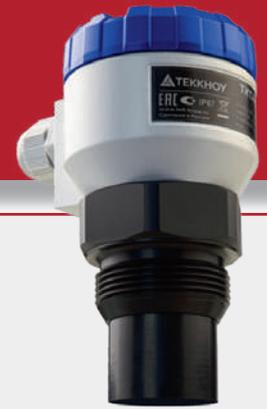
Уровнемер ультразвуковой излучает электроакустический сигнал в направлении к измеряемой поверхности. Отраженный сигнал принимается преобразователем и обрабатывается электронным модулем. Электроника измеряет время прохождения электроакустических сигналов к поверхности и обратно, вычисляет высоту уровня, вводит поправку на температурную погрешность и далее преобразует данные в выходной сигнал 4...20 мА с HART-протоколом или RS-485 Modbus/RTU. Измеренное значение уровня отображается на дисплее.
