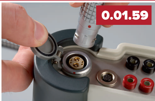
• Подключение кабеля датчика к блоку расходомера
