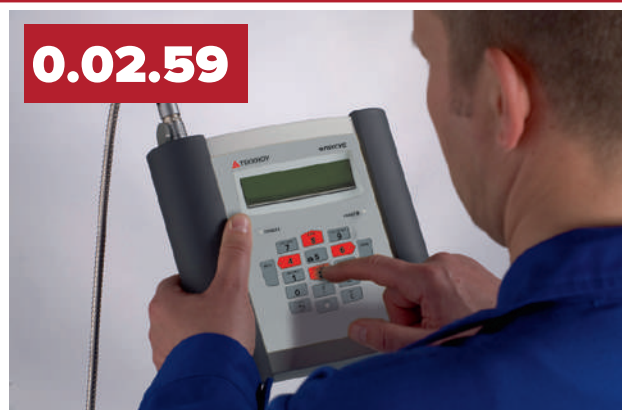
• Ввод параметров трубы и выбор среды измерения
