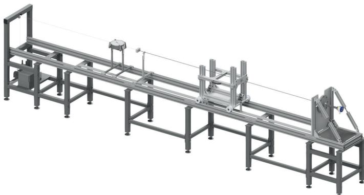
Модуль состоит из быстроразборных секций, для каждой из которых предусмотрен специальный транспортировочный кейс.
