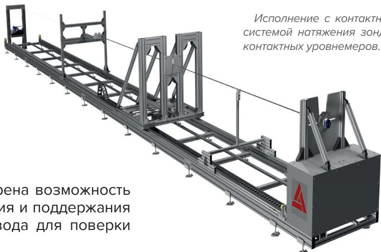
Исполнение с контактной пластиной и системой натяжения зонда для поверки контактных уровнемеров.
